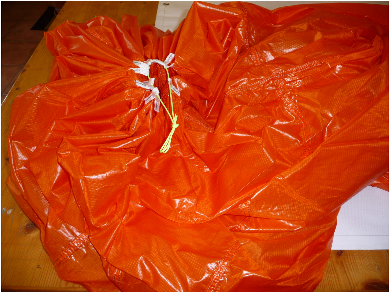
Abbildung 1: Zusammenfassung der Packschlaufen durch Hilfsschnur
