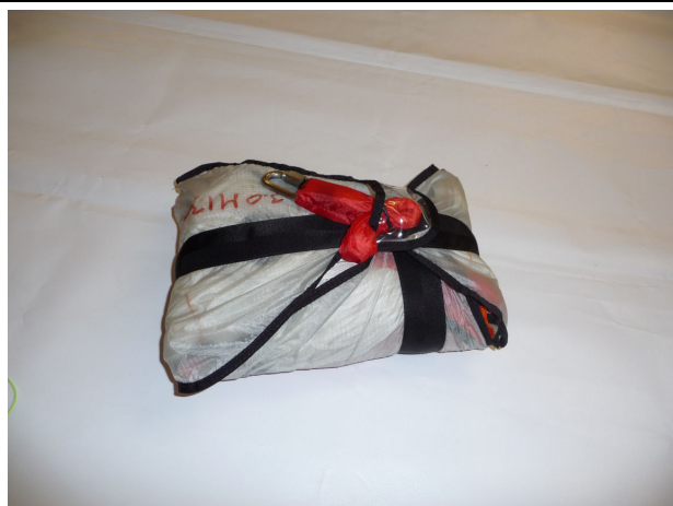
Abbildung 18: ... Verschlussgummi durch untere Fensterklappenöse führen und mit einer Leinenschlaufe verschließen. Leinenschlaufe hinter das Fenster schieben.
