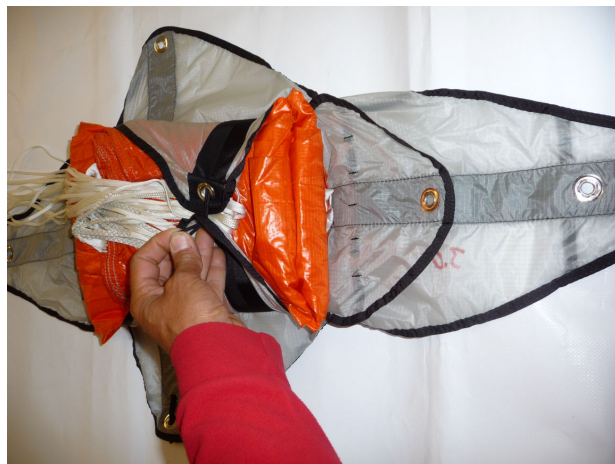
Abbildung 10: Verschußgummi der inneren Klappe durch die gegenüberliegende Klappenöse führen ...
