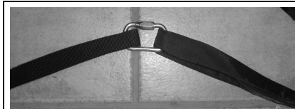
Abbildung 19: Verbindung mit Schäkel
