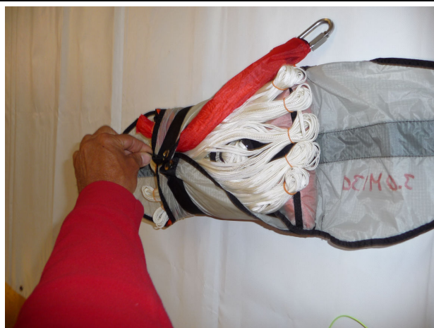
Abbildung 16: Verschließen der äußeren Klappen des Innencontainers, Verschlussgummi durch gegenüberliegende Klappenöse führen ...
