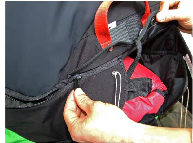
Führen Sie die elastischen Schlaufen in die kleinsten der an den Ecken des Containers vorhandenen Ösen ein. Bewegen Sie den Schieber der Abdeckung der Verbindungsleine ganz nach rechts, und schließen Sie dann den Reißverschluss, indem Sie den Schieber etwa 20 cm nach links schieben
