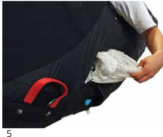
(1) Seitentasche "Anti-G", (2) Karabiner zum Einhaken der Verbindungsleine des Bremsfallschirms (3-4). Beispiel des Herausziehens des Fallschirms (5-6).
