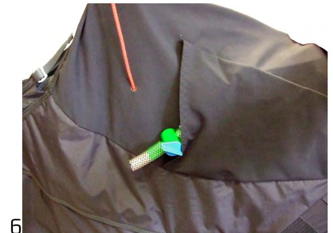
Den Reißverschluss unter der Instrumentenauflage (1) öffnen, um auf den Sitz des Ballastes zugreifen zu können (2), dann die Austrittsöffnung des Ablassschlauchs öffnen, die von einem Klettverschluss (3) verdeckt ist, und den Schlauch (4) hindurchführen. Im Inneren des Gurtzeugs befindet sich eine zweite Öffnung (5), durch die der Ablassschlauch zur äußeren Tasche verlegt werden kann; in dieser kann er aufbewahrt und bei Bedarf herausgezogen werden (6).
