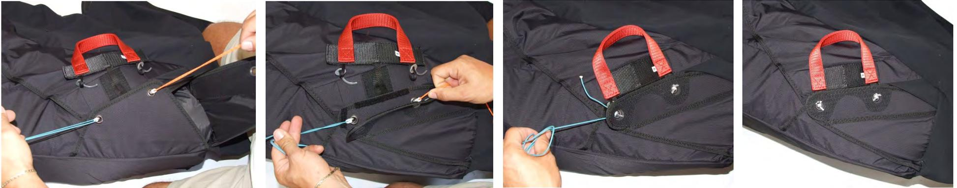
Führen Sie die metallischen Splinte in die elastischen Schlaufen unter der transparenten Abdeckung. Die Leine, die zur Hilfe genommen wurde, muss nun unbedingt entfernt werden. Ziehen Sie die Leine langsam heraus, um die elastischen Schlaufen nicht durch zu hohe Reibung zu beschädigen. Am Ende wird der Griff unter der elastischen Abdeckung eingesetzt.
