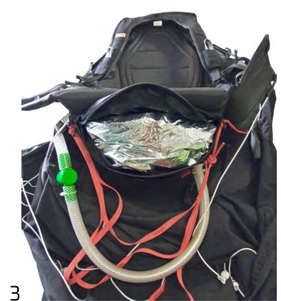
Der Sitz des Ballastes befindet sich unter dem Sitzbrett: Um darauf zuzugreifen, den Reißverschluss öffnen (1). Dann den Ablassschlauch durch die Öffnung auf der rechten Seite (2) führen und den Ballast einsetzen (3).
