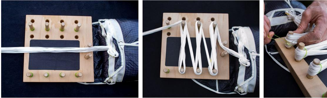
Die Fangleinen sind in drei Bündel sortiert, die durch Gummis fixiert werden. Diese Bündel werden in der Tasche des Containers aufbewahrt.
