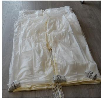
Verwenden Sie zum Packen des Rettungsgeräts ein kurzes Stück alte Gleitschirmleine und fädeln Sie es durch alle Apex-Befestigungsschlaufen. Die Befestigungsschlaufen sind an der Kappe angenäht.
